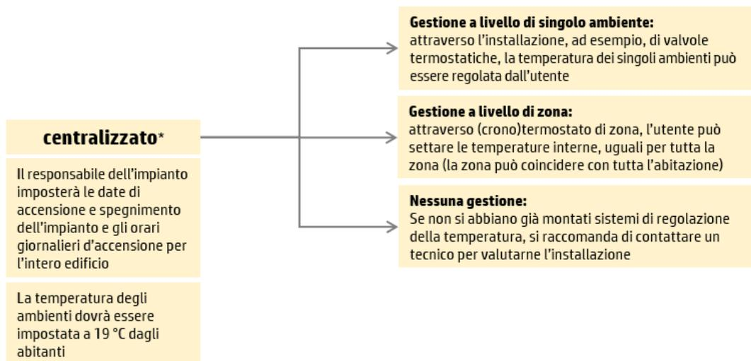
\*salvo deroghe, il Dlgs 102/14 impone l'obbligo di installazione di sistemi per la contabilizzazione del calore per ciascuna unità immobiliare
