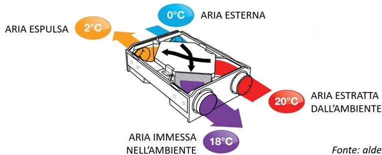
Il recuperatore è un dispositivo all'interno del quale l'aria calda in uscita dall'ambiente cede calore all'aria nuova in entrata: sarà necessaria quindi meno energia per riscaldare l'abitazione!
